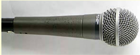
ダイナミックマイク コイルを使った一般的なマイク
